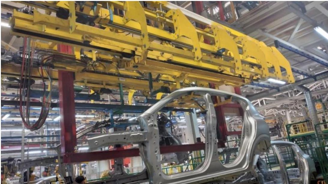
Figure 34: Ensemble élévateur
