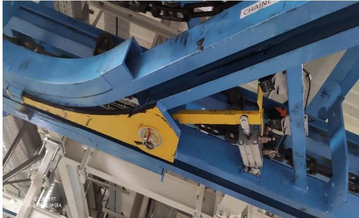
Figure 37: Système d'aiguillage
