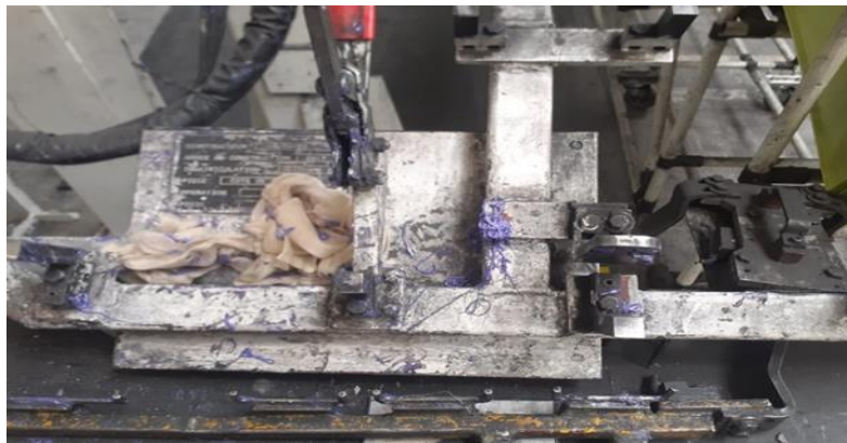
Figure 40 : La saleté du moyen de poste d'encollage 15
