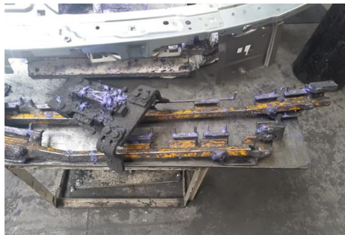
Figure 38 : Les 3 gabarits du poste d'encollage 15
