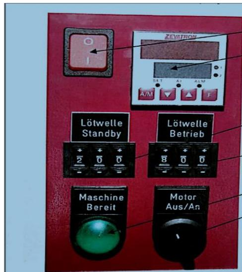
Figure 12 : Régulateur de température
