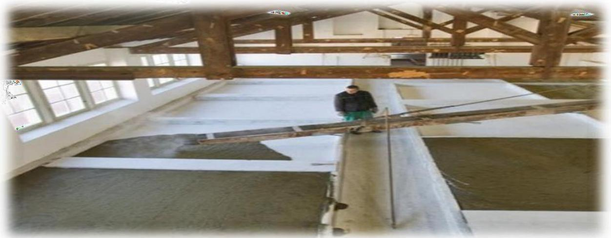
Figure 23 : la Etape 5 de la saponification à chaud (*Coulée de la cuite dans des moules*)
