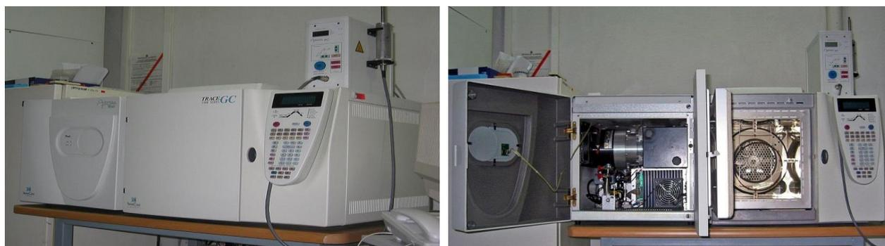
Figure 30 : Exemple d'un appareil CPG-SM
