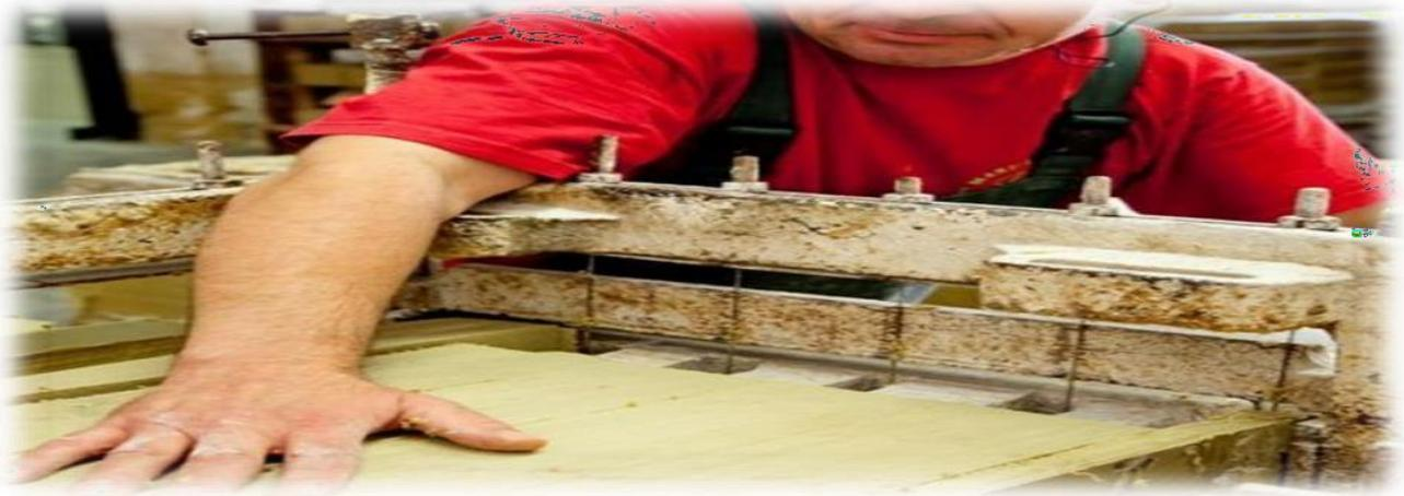
**Figure 24 :** Etape 6 de la saponification à chaud (*Le découpage la pâte savonneuse après son séchage*)
