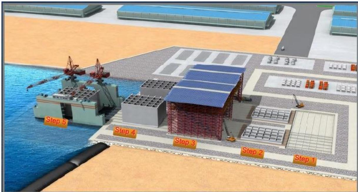
**Figure 3 : La chaîne de préfabrication des caissons.**
