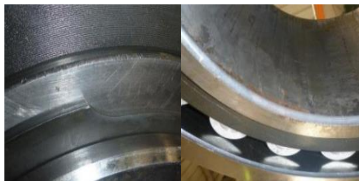
Figure 2.12: Roulement avec rayures et écaillages
