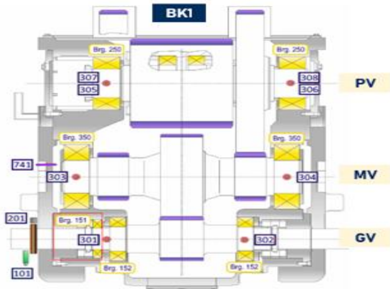
Figure 2.14: Les groupes GV, MV et PV du réducteur BK1
