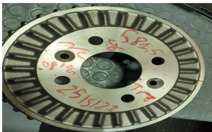
Figure 27 : Photo d'une pièce rebut à cause de balourd
