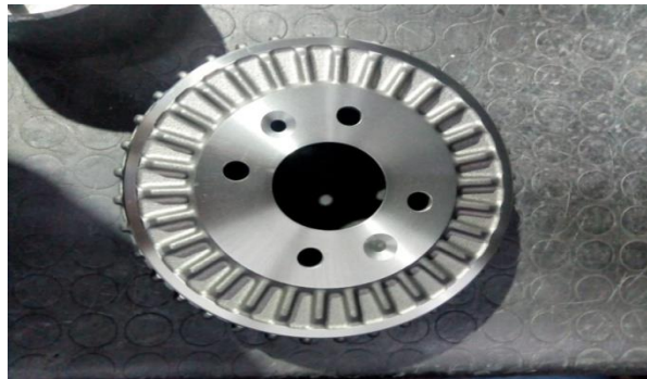
Figure 8 : perçage et taraudage de la pièce
