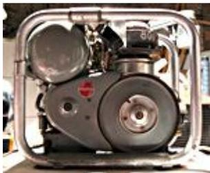
Après la seconde guerre mondiale, Philips a mis au point et commercialisé le groupe électrogène dont on voit la photo ci-contre. Ce groupe avait une puissance de 150 watts environ.
