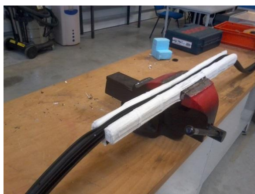
Figure 35 : serrage du joint
