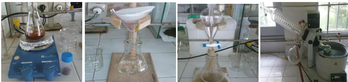
Figure 13 : Les différentes étapes d'extraction discontinue des résidus de pesticides (1 : agitation, 2 : filtration, 3 : décantation et 4 : concentration)
