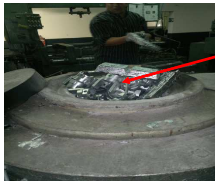
Figure 4 : la fusion des alliages dans le four
