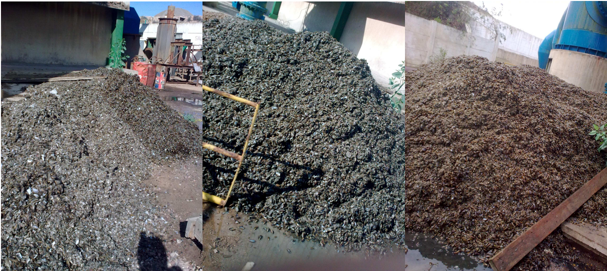
Figure 16 : les résidus de nettoyage du bassin de pompage :
