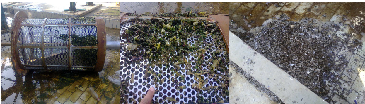
Figure 20 : Nettoyage de moules et d'algues bloquées par le filtre :
