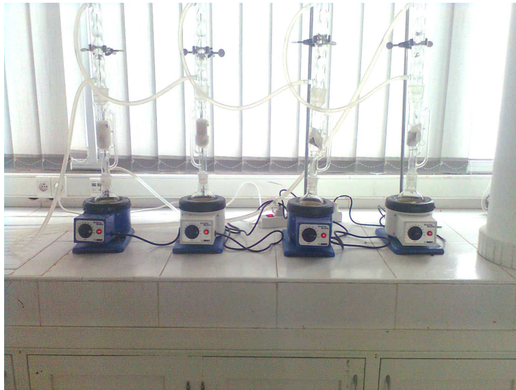
Fig1. Montage de l'extraction par la méthode de Soxhlet
