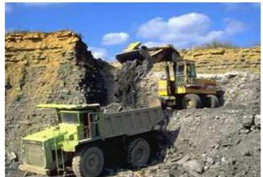
**Figure 5 : Extraction du calcaire depuis la carrière**
