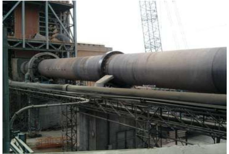
Figure 11: photo du four rotatif
