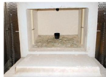
Figure 22 : Creuset en Ni dans le four de  $500^\circ\text{C}$
