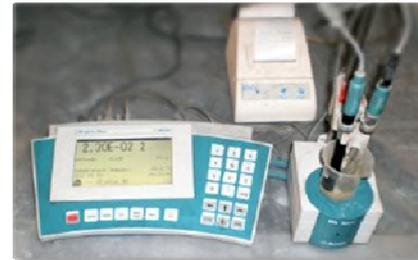
Figure 27 : Ionomètre/pH- mètre de la marque METROHM
