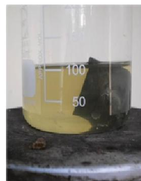
**Figure 25 :** Dissolution de la masse calcinée dans l'acide.
