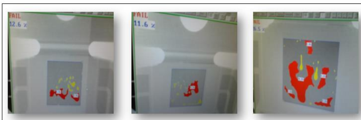
FIGURE 46: ANALYSE X-RAY DE PIECES PRESENTANT UN POURCENTAGE DE BULLES D'AIR ELEVE
