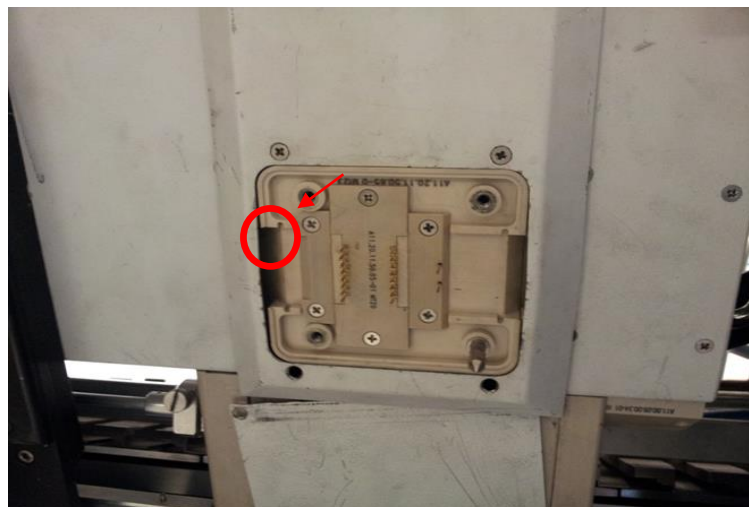
FIGURE 38: ETAT DES UNITES DE CONTACT DE LA MT13
