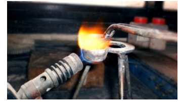
Figure 10: Attaque du creuset par un chalumeau contenant du butane.
