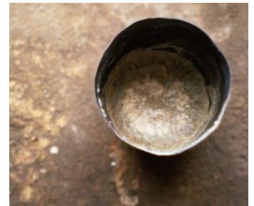
Figure 11: Creuset refroidi (3 minutes après l'attaque par chalumeau).
