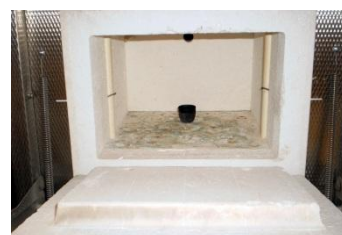
Figure 9: Creuset en Ni dans le four à 600°C.
