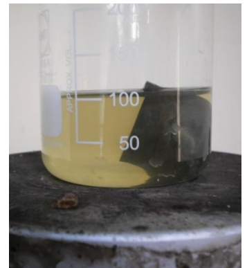
Figure 12: Dissolution de la masse calcinée dans l'acide.
