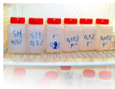
Figure 16: Standards préparés à partir de NaF pour l'étalonnage d'ionomètre.
