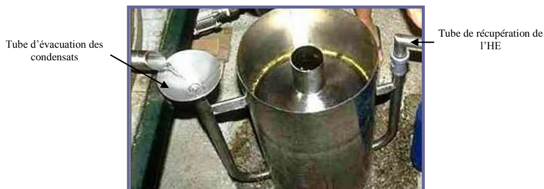
Photo 19: Un séparateur (essencier)
