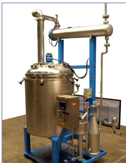
Photo 17: Hydrodistillateur à capacité 1000 L
