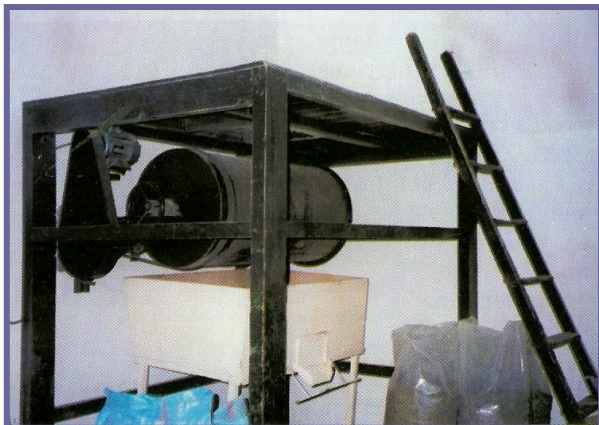
Photo 10: Malaxeur à tambours pour le mélange des plantes
