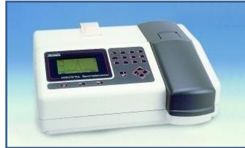
Photo 24: Spectrophotomètre (UV/visible) utilisé
