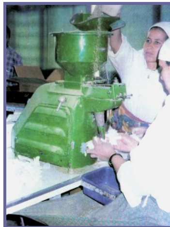
Photo 12: Remplissage des sachets à l'aide d'une doseuse
