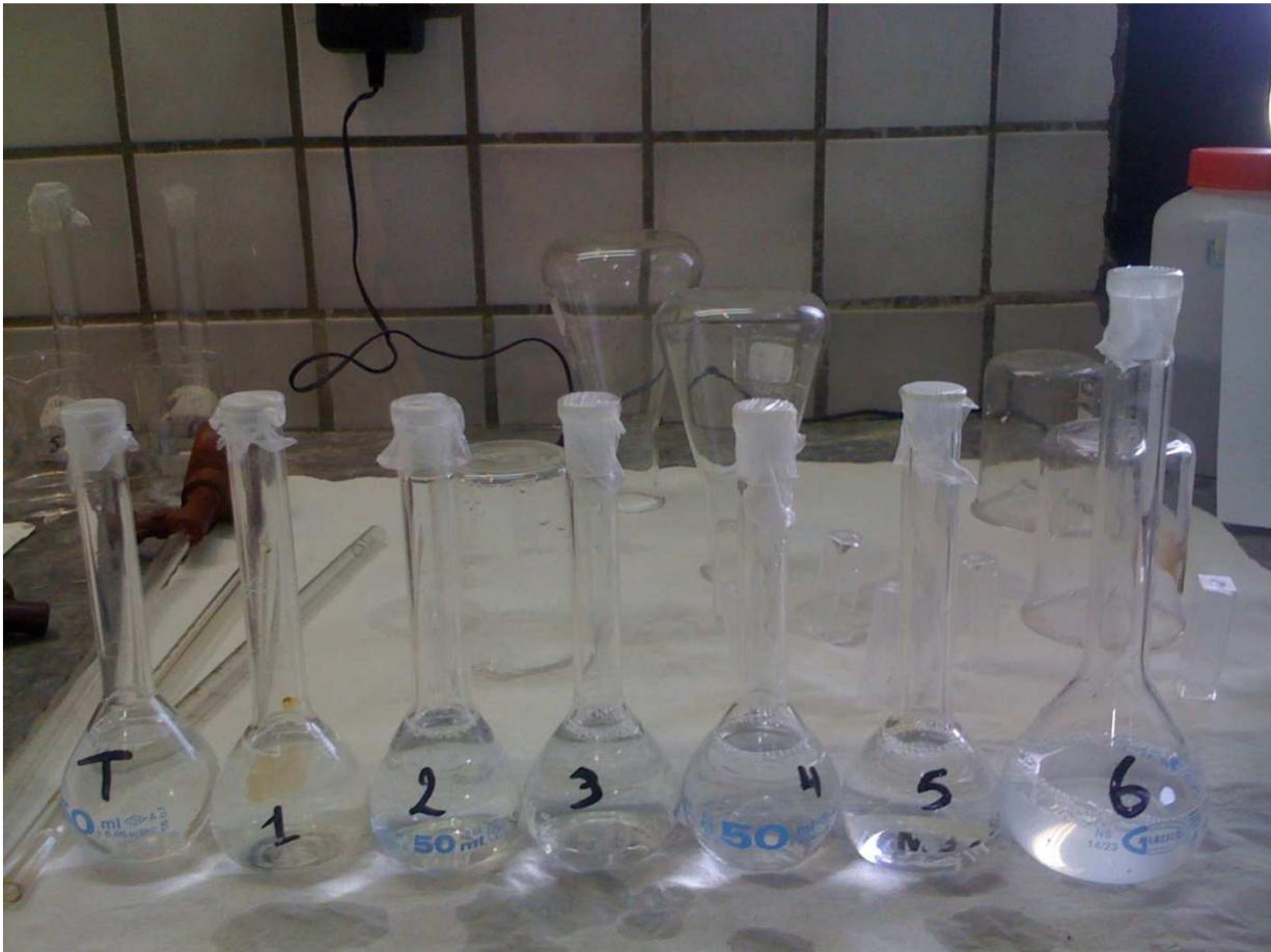
**Figure 2 : Préparations de la gamme d'étalonnage**
