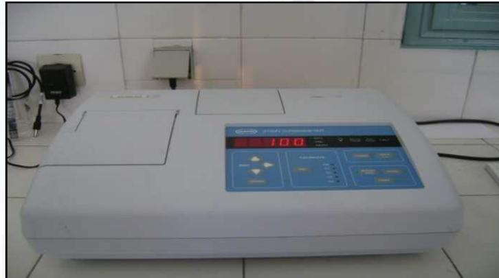
Figure 4: Turbidimètre
