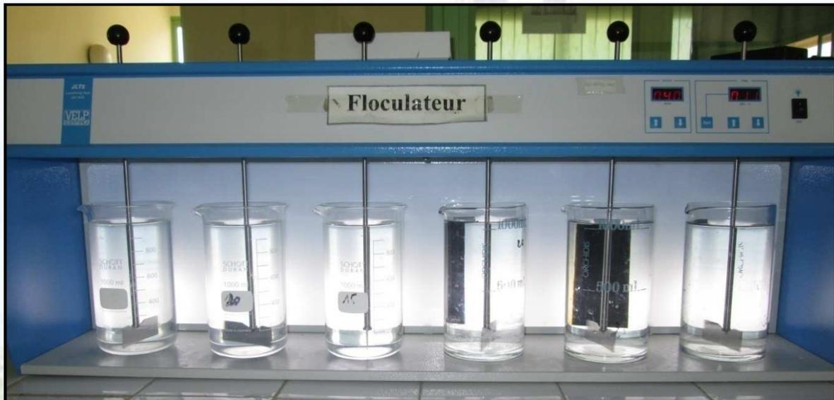
Figure 10: Dispositif expérimental de l'essai de floculation (Jar-Test)
