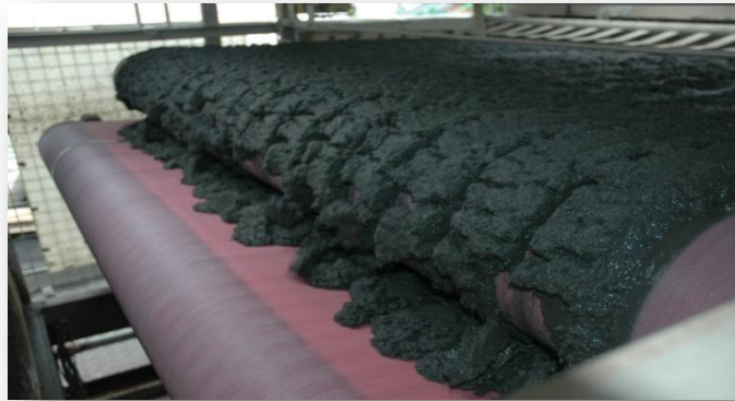
Figure 7 : Déshydratation de la boue
