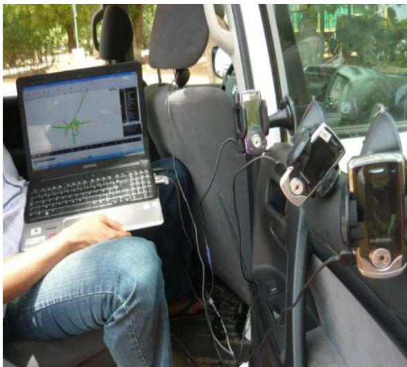
Figure 1: Chaîne de mesures en opération sur terrain
