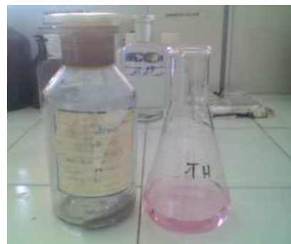
une pincée de l'indicateur coloré noir d'ériochrome
