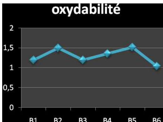
Figure10 : Courbes du pH, oxydabilité, turbidité filtré et aspect du floc d'essai 6.
