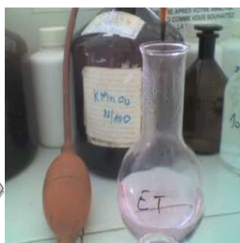
on effectue un dosage en retour par \text{KMnO}_4
