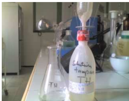
100 ml d'échantillon + 5 ml de Solution tampon
