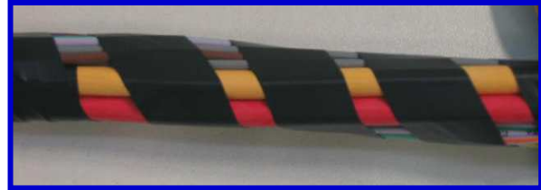
Photo 12 : enrubannage en spirale
