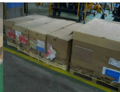
Figure 34 : Etat dégradé des palettes
