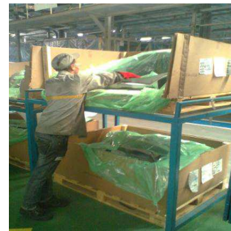
Figure 28: Support de stockage de palettes inadéquat
