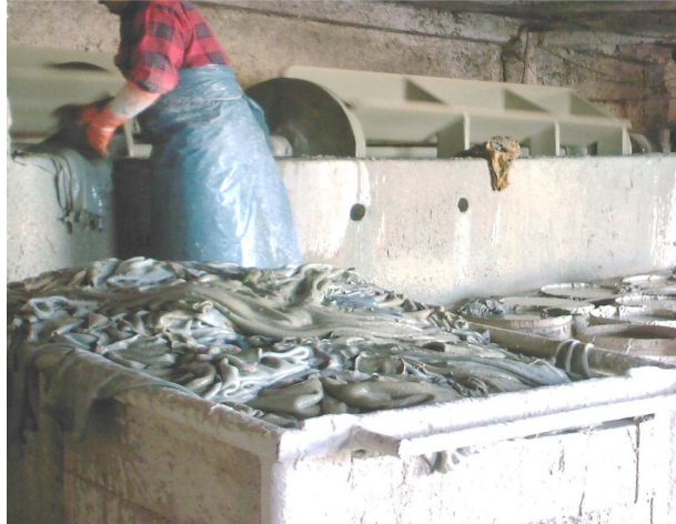
Photo 2: Coudreuse dans la quelle on prépare les peaux tripe
