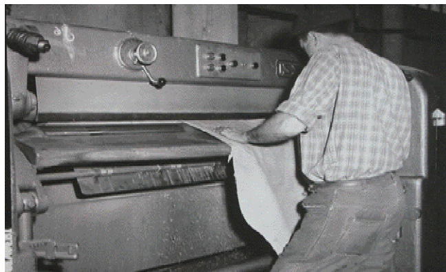
Photo 6: Dérayeuse par laquelle on égalise l'épaisseur.
