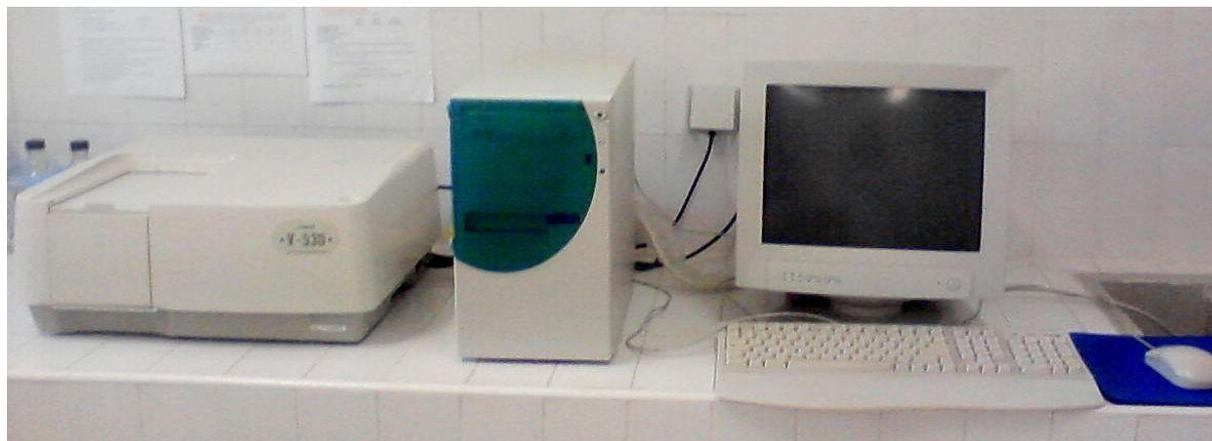
**Figure 10 : spectrophotomètre UV-Visible Jasco V-530**
