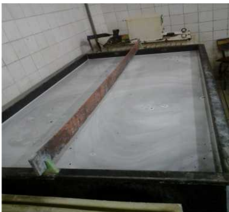
Photo 15 : Bain de dégraissage.
