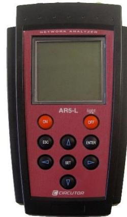
Figure 8 : Analyseur de réseaux AR5L<sup>4</sup>
